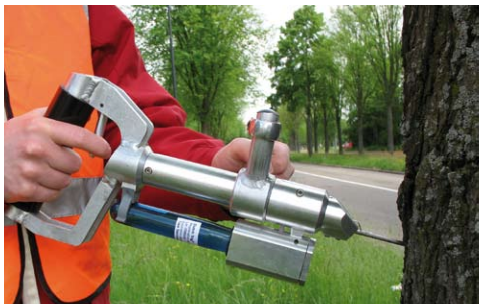
Foto 5: Injecteren van Dutch Trig
